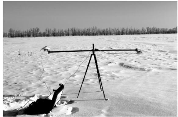
图 1 积雪反照率观测示意图
